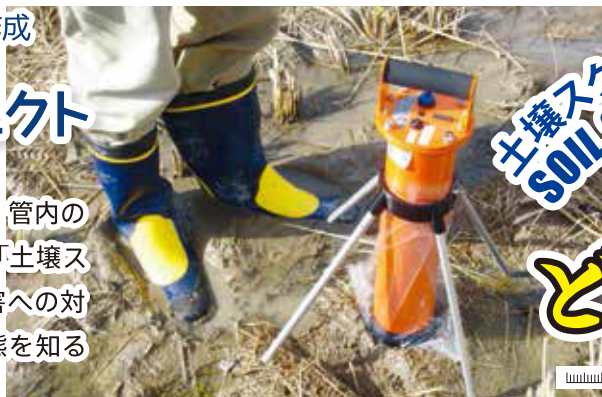
▲サーベイメーターによる土壌表面からのベクレル/kgの測定
