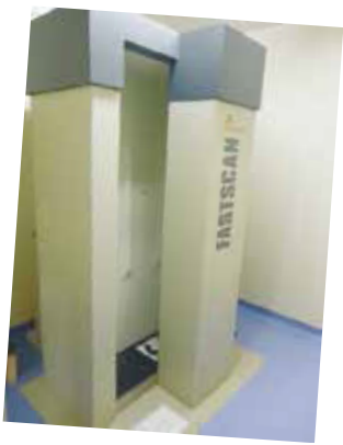
わたり病院北側（旧通所リハビリセンター）の放射能対策センターに設置されているホールボディカウンター
